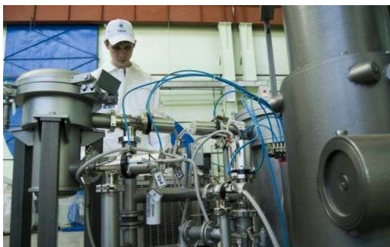
Участок производства комплектующих СПМ (проверка на герметичность)
